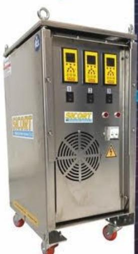
هي عبارة عن أجهزة معالجة حرارية (منخفضة الجهد). يقوم الجهاز بإجراء عملية التسخين المسبقة ثم بعملية المعالجة الحرارية للوصلات الملحومة (خطوط الأنابيب، الخزانات، أنواع الربط المواتنات، الأكراع، وغيرها) بكافة أنواعها وأحجامها. يتيح استخدام هذه الأجهزة من التضورات التالية: الإجهاد الذي تتعرض له المادة خلال عملية اللحام والذي قد يتسبب في الكسر إن لم يتم السيطرة عليه.
